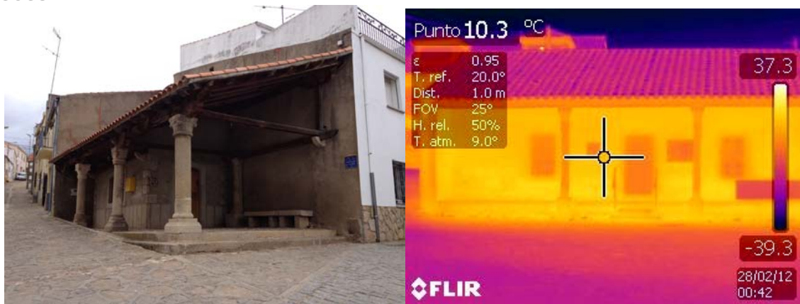
Figura 3 Estudo termográfico de alpendres
